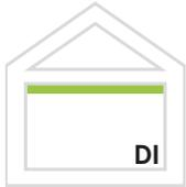
**DI** Innendämmung, der Decke (unterseitig) oder des Daches, Dämmung unter den Sparren/Tragkonstruktion, abgehängte Decke
